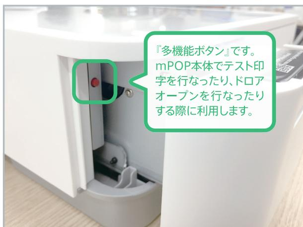
本体の左側、レシートプリンター部分を奥に押しと手前に開きます。(ロール紙の交換時に行なう操作です) 開いた内側、プリンターと本体の間に赤いスイッチ(『多機能ボタン』)があります。ボタンを長押し(1秒以上)すると、ドロアが開きます。 ※本操作でドロアオープンが行えない場合は、物理的な強制オープンの操作が必要になります
