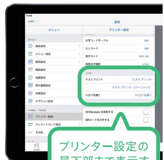
プリンター設定の最下部まで表示すると、【その他】にテストプリントなどの項目があります。プリンターの動作確認を行えます。
