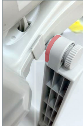
ネジの固定部を限界まで下げると、自 動的に正しい読み取り位置になります。 飛び出しが無いか確認してください
